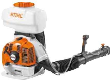
SR 440 63,3 cm³, 2,9 kW/3.89 HP, 20 L, 12,2 Kg*. Potente fumigadora de gran alcance. Con depósito de 20 L y motor 2-MIX. Bajo consumo de gasolina y bajas emisiones de gases contaminantes. Sistema de arranque simplificado, correas cómodas y empuñadura multifuncional de una mano. De serie con rejilla cónica de desvío, rejilla de desvío y rejilla de doble desvío.
