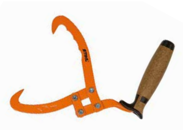
MORDAZA DE AGARRE Abertura de 18,5 cm. Puntas forjadas, mango de dos componentes (corcho y plástico), con cavidades para los dedos en el mango. Para girar y transportar troncos.
